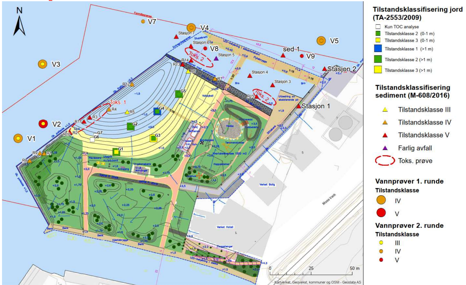
Figur 5: Illustrasjonskart med oversikt over prøvepunkter for forurenset grunn, sedimenter, vann og toksisitetstester tatt ved Rabben i 2021/2022 (2013). Prøvepunktene (uavhengig av prøvedybde) er fargekodet etter høyeste påviste tilstandsklasse (jordprøver iht. TA-2553, sediment og sjøvann iht. M-608).
