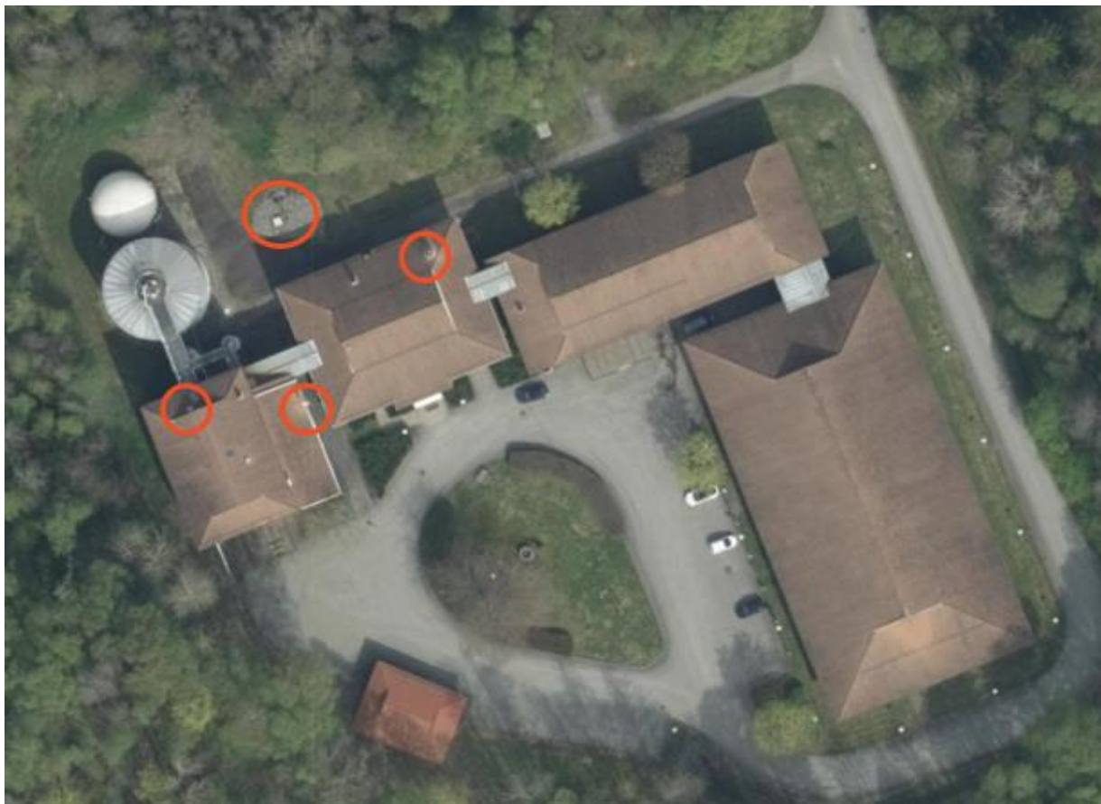
Figur 8. Utslipp til luft ved eksisterende anlegg, markert med røde sirkler. Lengst til venstre: avtrekk fra gassrommet, luktjerning med kullfilter. Øverst: Fakkell. Nederst eksosrør fra gassturbin. Lengst til høyre avtrekk fra slambehandlingen, luktjerning med hypokloritt.
