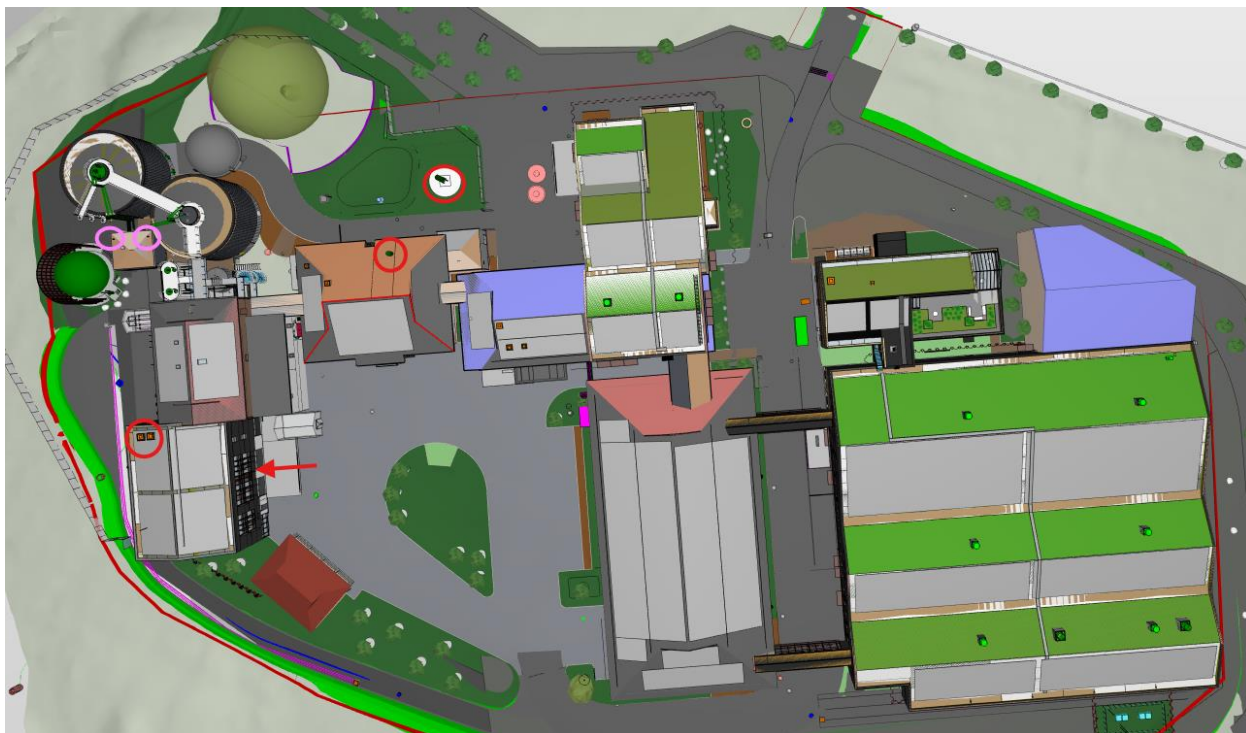
Figur 10. Modellutklipp fra nye Fuglevik RA. Rosa sirkler viser avtrekk fra kullfilter i rom for overløpskar fra råtnetank. Rød sirkler fra venstre: Avtrekk fra slambehandling, eksosrør fra gassturbiner, fakkell. Rød pil viser område for slamutlastning, hvor det kan oppstå diffuse utslipp til luft.
