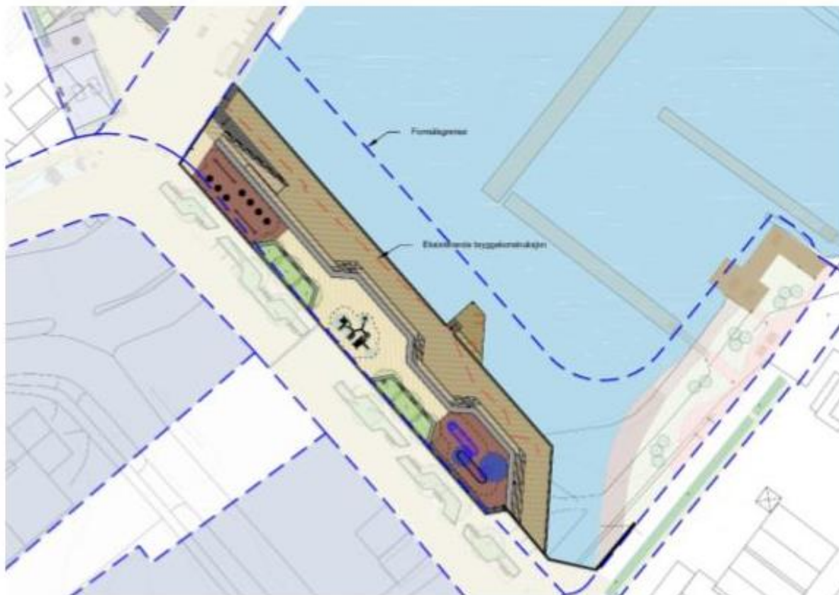
Figur 3. Foreløpig forprosjekt-tegning som viser en liten brygge med utkraging inntil 3,5 m.
