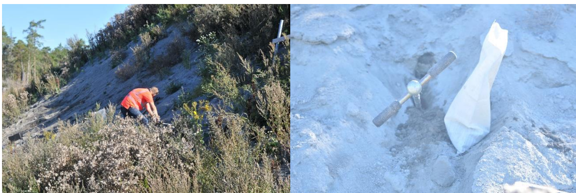
Figur 12. Bilde til venstre viser tilstand til 100 meters banens kulefangervoll hvor miljørådgiver er i gang med å bore seg horisontalt inn i vollen der hvor hovedandelen av kulene slår inn. Bilde til høyre viser et prøvepunkt i transektet med jordboret ca. 0,7 meter inn i vollen. Striesekken inneholder prøvemateriale fra 0,5-0,7 meters dyp under uttak av prøvemateriale fra vollen før blanding i plastbøtte.
