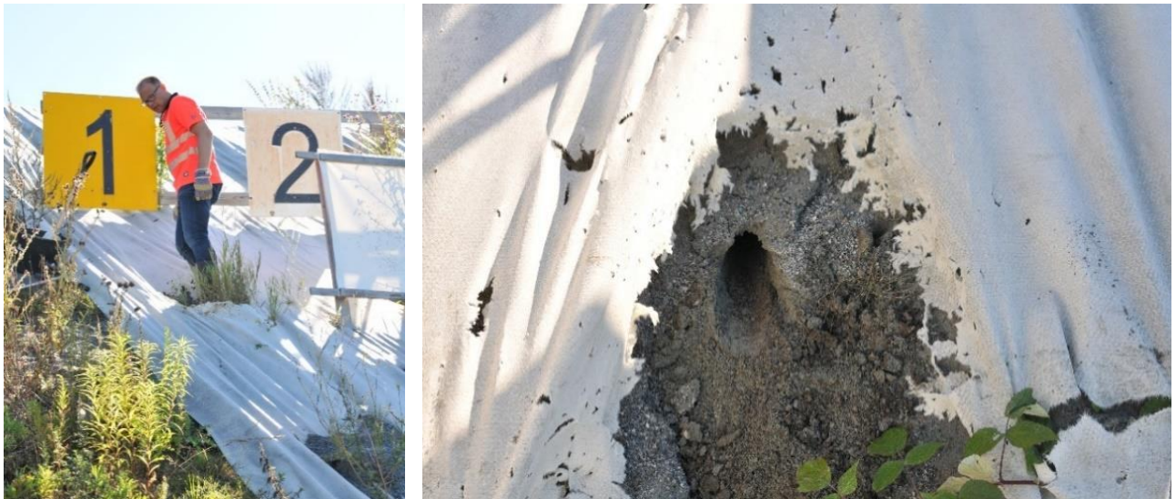
Figur 13. Bilde til venstre viser miljørådgiver stående i ett av de åpne (opprevede) punktene hvor kulene slår inn bak senter av skiva det skytes på. Bilde til høyre viser det ytre laget av masser i vollen rundt et borepunkt.
