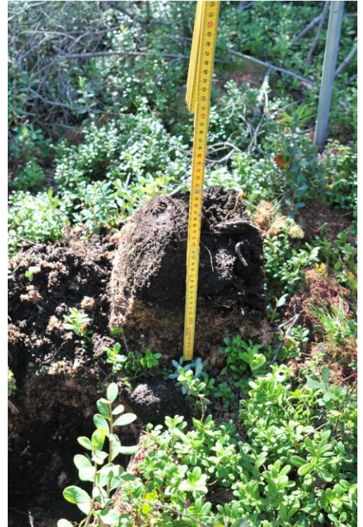
Figur 15. Bilde til venstre viser søkket i sydenden av kulefangervollen til 300 meters banen som streker seg vider ut til høyre med svakt fall i terrenget. Bilde til høyre viser en av de 20x20 cm stykkene med prøvemateriale som ble tatt opp. Det ble kun tatt ut prøve av det mørke organisk rike torvjordlaget.
