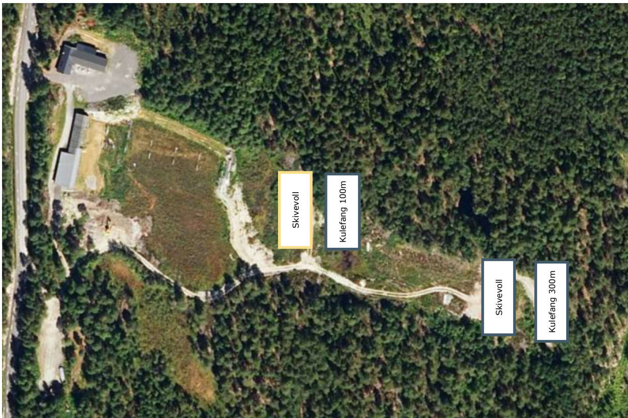
Figur 3. Flyfoto av Fjell skytebane i Våler kommune fra 2016 med inntegnede skivevoller og kulefangervoller.
