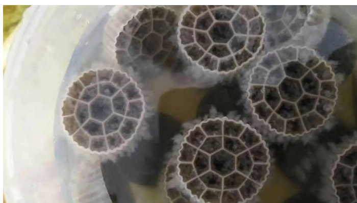
Figur 5.4-1: Biofilmbærere i en MBBR-prosess ( Moving Bed Biofilm Reactor (MBBR Media)-BIOETP )
