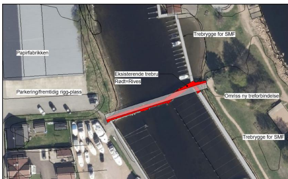
Figur 1-2: Flyfoto med omriss av ny forbindelse (grå skravur) og forbindelse som skal rives (rød).
