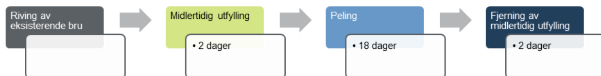
Figur 1-5: Planlagte anleggsarbeid og estimert tidsomfang per aktivitet.
