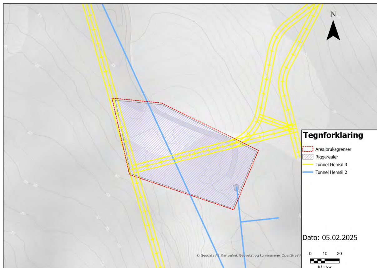
Figur 29: Arealbruk for overflatearbeider/lagerområder ved forbindelsen mellom tunnelene for Hemsil 2 og 3 kraftverker. Det vil bli etablert lukehus like ved der vannveiene krysses.
