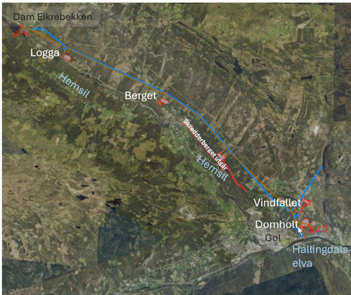
Figur 11: Vesentlege anleggsdeler/område for Hemsil 3 kraftverk.
