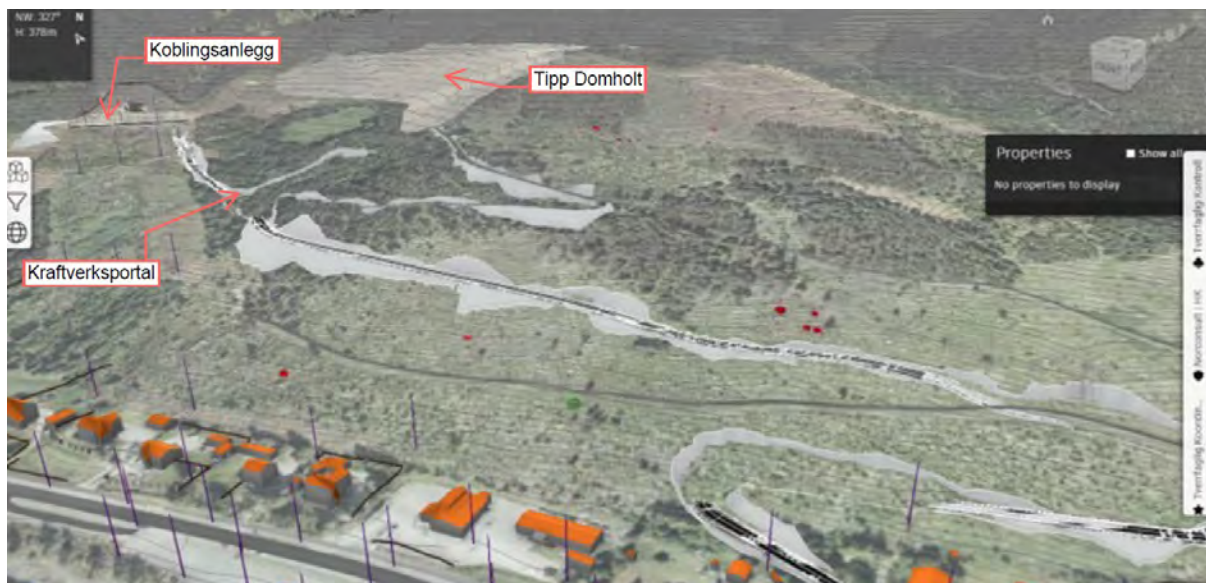
Figur 13: Illustrasjon av ny vei med fyllinger og skjæringer mot kraftverksportal m.m.
