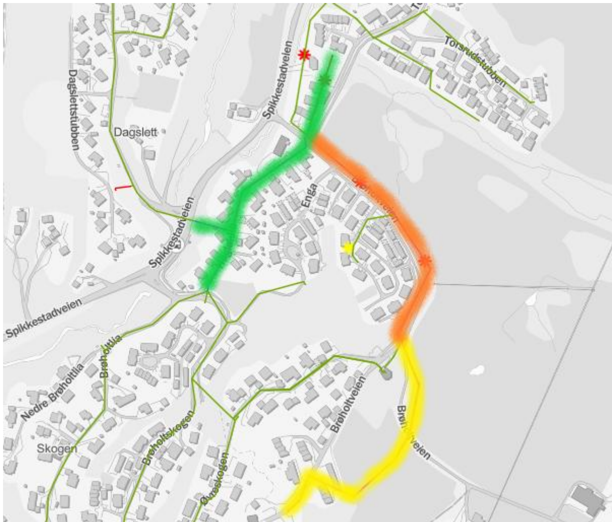
Figur 10 Utvalgte ledninger til fornyelse. Fargekoder viser prioritet fra 1 (rød, haster mest) til 5 (grønn, haster minst)
