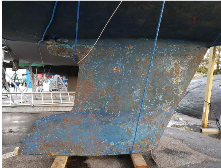
Bilde 5.1 Eldre seilbåt med flere typer bunnstoff (COWI)
