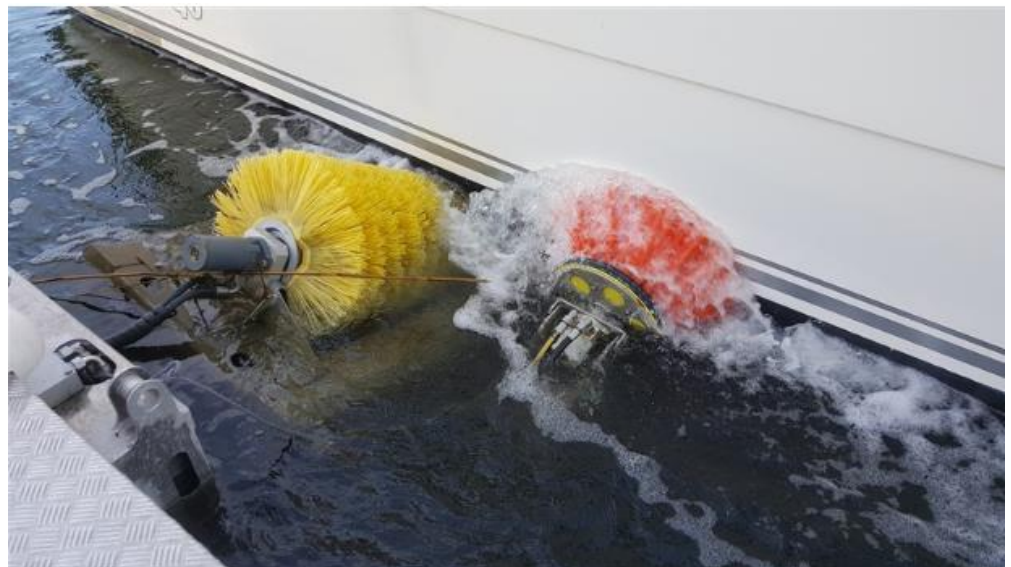
Bilde 8.1: Børster til et båtvaskeanlegg ( www.vollenmarinesenter.no )
