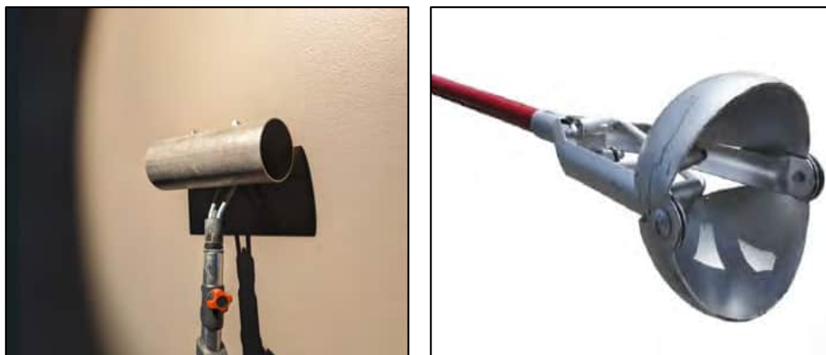
Figur 5. Til venstre hjemmelaget slamprøvetaker. Til høyre IMKU slamprøvetaker [11].
