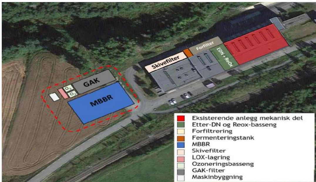
Figur 3. Envidans forslag til plassering av nye rensetrinn
