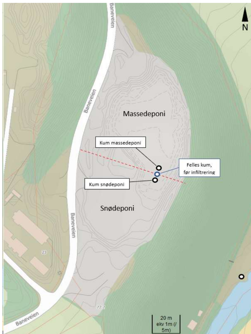
Figur 8. Skjematisk bilde som viser omtrentlig plassering av oppsamlingskummer på Egge Massedeponi. Derfra vil vannet ledes til infiltrasjonsgrøfter.
