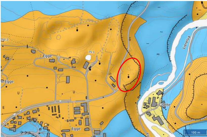
Figur 3. Utsnitt fra NGUs løsmassekart [3], der Egge Massedeponi vises med rød ring. Oransje farge tilsvarer breelvvasetning, og blå farge tilsvarer hav og fjordavsetning.
