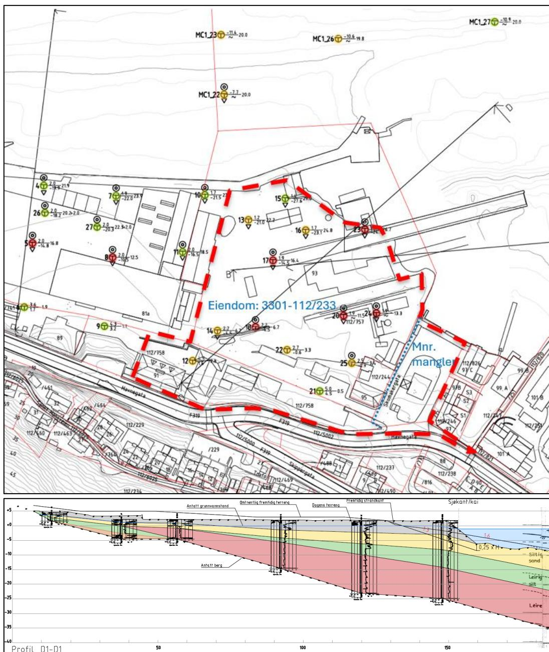
Figur 2 Kartutsnitt fra geoteknisk notat (1), som viser registrerte eiendommer, med modellert tverrsnitt av forventet grunnforhold (profil D-D'); rød stiplet linje viser omrent avgrensning tiltaksområde BT1 land (grunnlag: Multiconsult).
