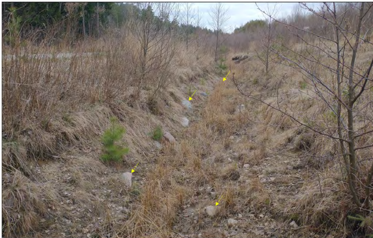
Figur 25 Veiskjæring i området vest av uttaksområdet viser relativt grove løsmasser typisk for morenemateriale. Det råder usikkerhet omkring løsmassenes opprinnelse, men eventuell tilstedeværelse av moreneavsetninger vurderes positivt for områdestabiliteten.
