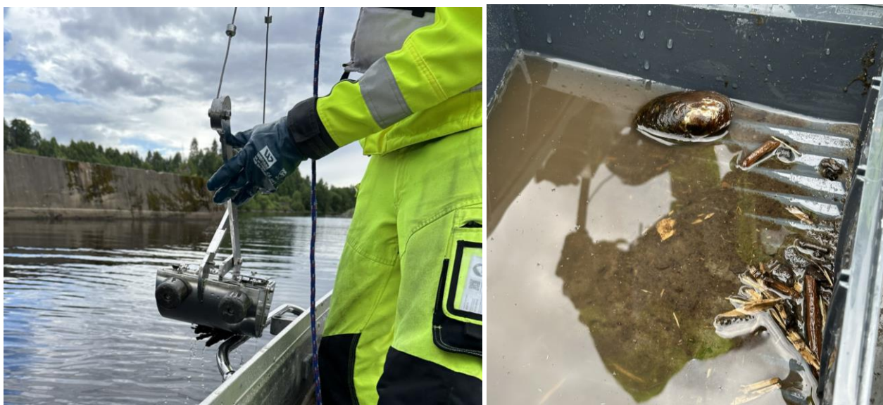
Figur 13. Van Veen grabb, benyttet til sedimentprøvetakingen vist i bilde til venstre. Musling vist i bilde til høyre.
