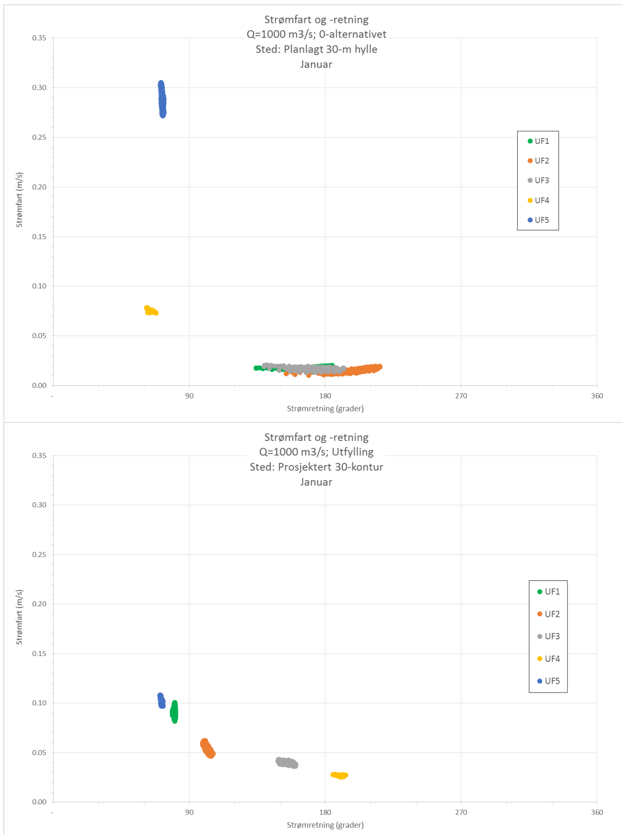
Figur 6-4 Strømfart og -retning i 5 kontrollpunkter på fyllingen, Q=1000 m 3 /s (simulering av ferskvannslaget) Øverst: dagens situasjon Nederst: Etter utfylling.
