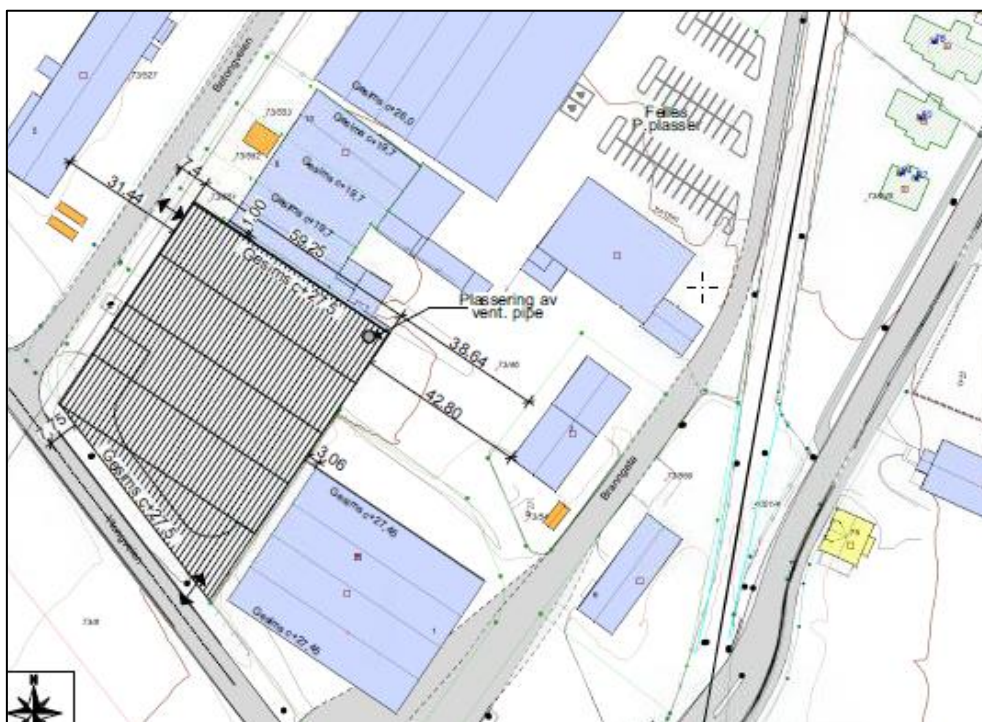
Figur 4: Utdrag fra situasjonsplan med plassering av ventilasjonsavkast
