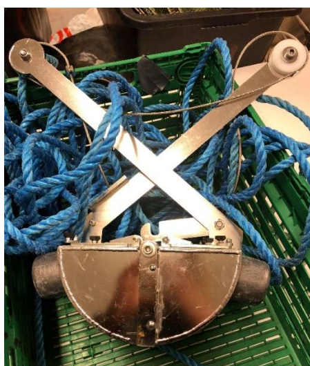
Figur 2-2: Bilde av grabbprøvetakeren.
