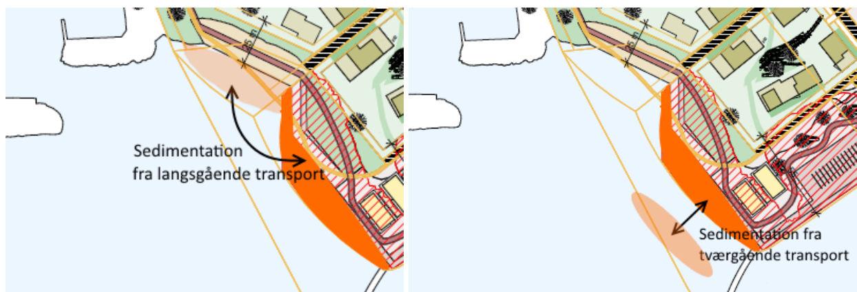
Figur 8: Illustrasjon av sedimentasjon som følge av langsgående transport (venstre) og tværgående transport (høyre).
