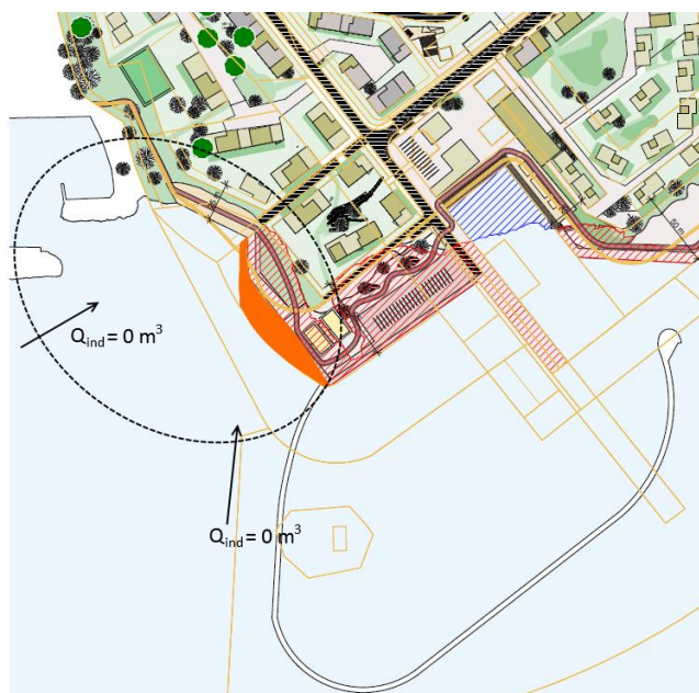
Figur 7: Illustrasjon av "sedimentcelle" (stiplet strek) som indikerer innramningen av planlagt kunstig strand ift. sedimenttransport.
