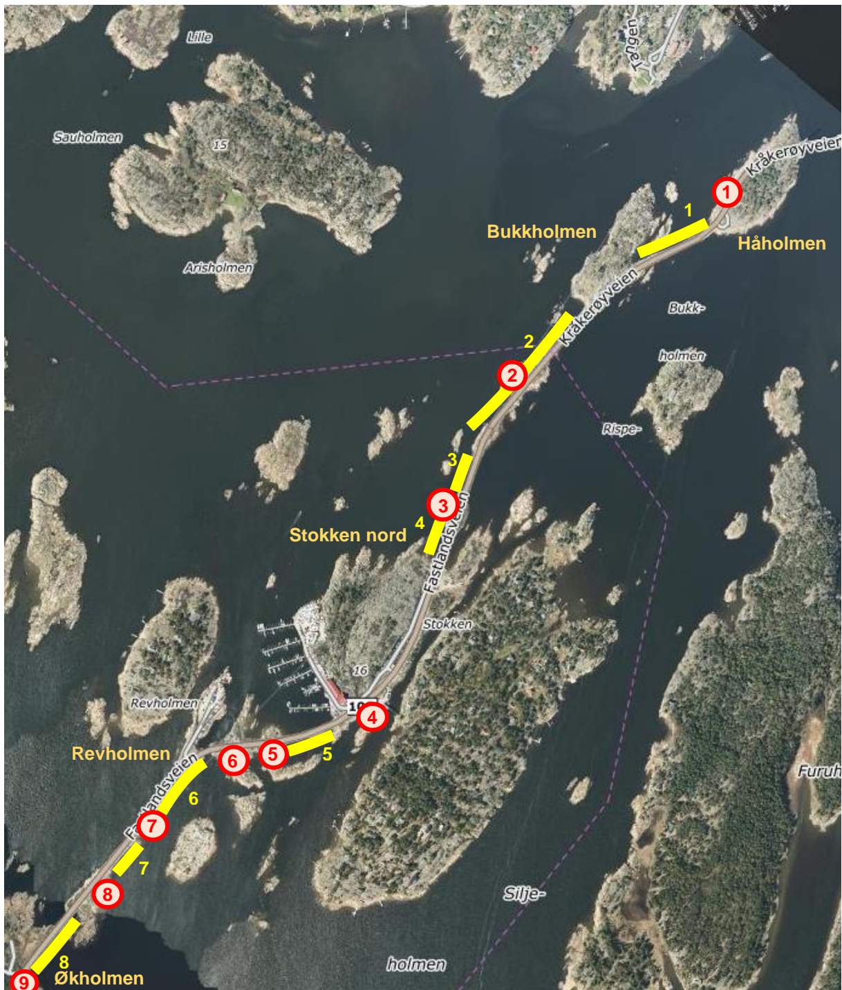
Figur 4 Oversiktskart over Entreprisen EP1.1 – Føringsvei for kabel og G/S-veg Håholmen – Økholmen. Skissert plasseringer av utfyllinger i sjø er markert med gule striper. Røde sirkler og tall viser sprengningslokalitetene.
