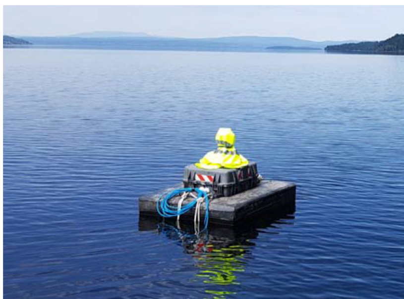
Figur 1-6: Miljøbøye for automatisk overvåking av vannkvalitet i Holsfjorden (HOL-N) utenfor utløpet av Nordlandsbekken. Det var her installert sensorer for målinger i tre dyp (1, 9 og 14 m).
