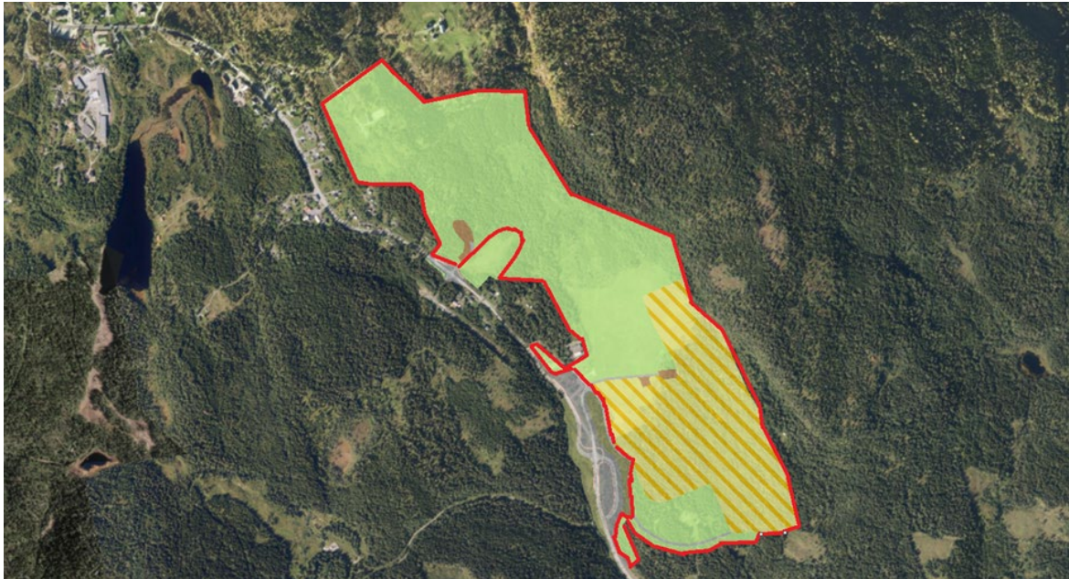
Figur 2-7: Illustrasjon av rigg-/anleggsområder og områder for midlertidig og evt permanent lagring, samt bearbeiding av masser ved Avtjerna. Avgrensning av områder tilgjengelig for prosjektet er vist med rødt omriss. Reguleringsplanens formålsflater vist i bakgrunnen.
