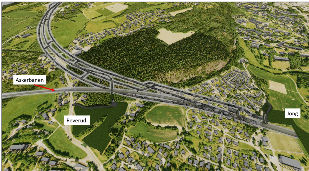
Figur 2-1: Illustrasjon som viser tunneler etter avgreining fra Askerbanen ved Jong. Riggområder ved Jong og Reverud er gitt en mørk grønnfarge.
