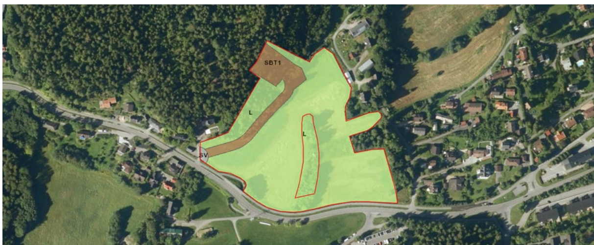
Figur 2-4: Illustrasjon av adkomsttunnel og riggområde på Åsjordet ved Reverud. Rigg- og anleggsområde ved adkomsttunnelen er markert med rød linje. Reguleringsplanens formålsflater vist i bakgrunnen. Permanent atkomstveg/baneformål er vist med brun farge.
