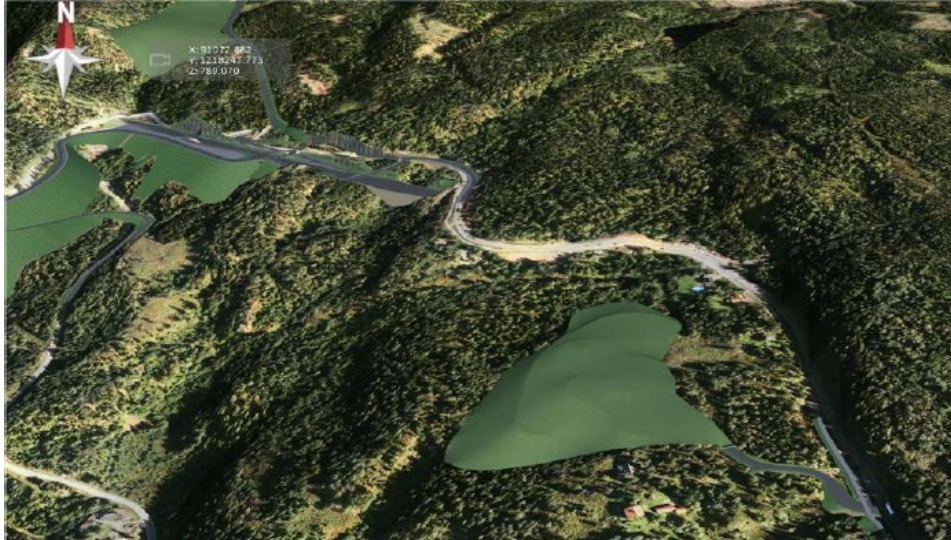
Figur 2-8: Illustrasjon av mulig utforming av masselager Brakamyrr. Området får atkomst fra eksisterende E16. Illustrert fylling innebærer oppfylling av terreng med ca 500 000 \text{pam}^3 masser.
