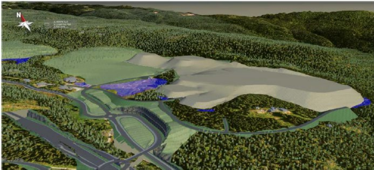
Figur 2-14: Illustrasjon av mulig oppfylling for ressursbank, markert med lys grå farge. Ringeriksveien og planlagt E16 til venstre i modellbildet. Bygging av disse veiene omfattes ikke av prosjektet. Område merket med blått er områder som kan brukes til vannbehandling.
