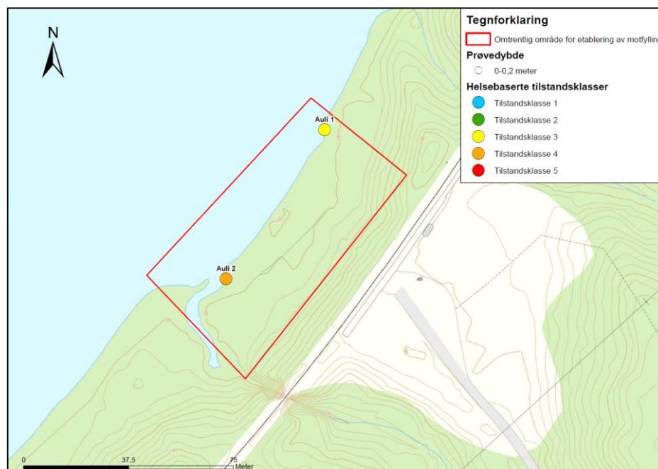
Figur 9: Plassering av prøvepunkter med forurensningstilstand ved Auli stasjon, fargekodet iht. Miljødirektoratets helsebaserte tilstandsklasser. Figuren viser den høyest påviste forurensningsgrad av et metall eller en forbindelse uavhengig av type påvist forurensning.
