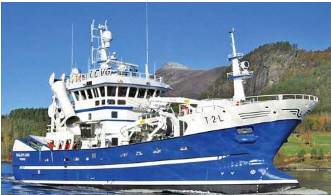
Figur 3. Fugløyfjord, LOA 34 m, bredde 9,5 m og dypgang 5 m. (Bildet fra Shipbase)
