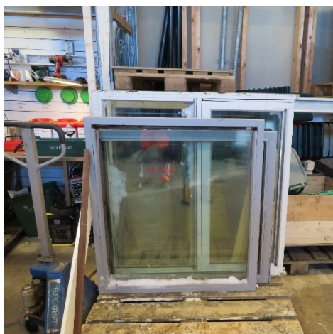
Bilde 1: Miljøborg Reipå 11.03.2019, lagring av klorparafinholdige isolerglassruter
