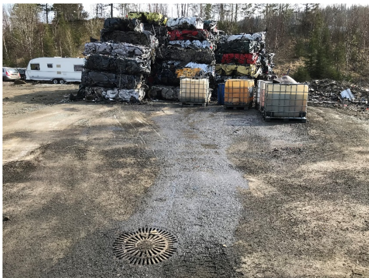
Bilde 1 Nypressede bilvrak plassert på betongplate med avrenning til oljeutskiller
