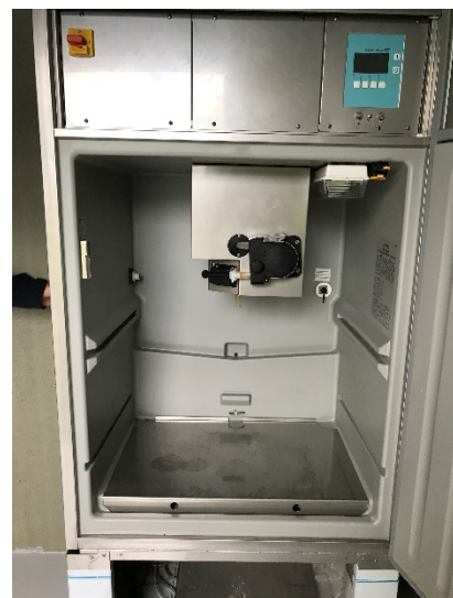
Bilde 3: Automatisk prøvetaker av sigevann fra avfallsdeponiet på Vikan, 21.06.2019. Prøven som tas ut her skal gi et samlet resultat for utslipp av sigevann, det vil si både sigevann etter rensning og eventuelt sigevann som har gått i overløp.
