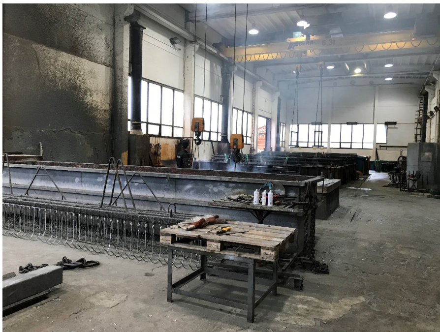
Bilde 1 , produksjonslokalet for varmgalvanisering hos Galvano Industri AS
