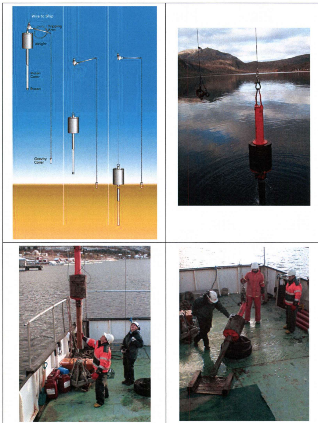
Figur 2 Prinsippskisse for prøvetaking med "pistoncorer". Multiconsults "pistoncorer" i bruk.
