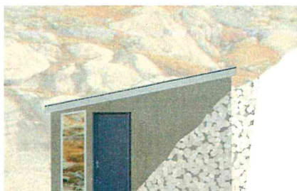
Figur 3.3 Typetegning for utforming av lukehus/pumpehus i skjæring
