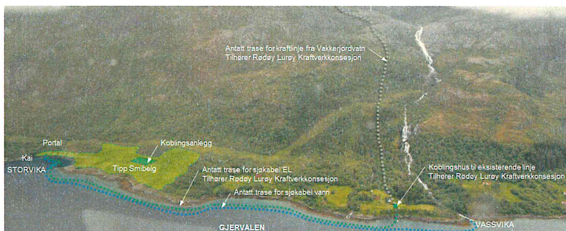
Figur 4.26 Skjematisk oversikt over permanente anleggsdeler nær Vassvika.
