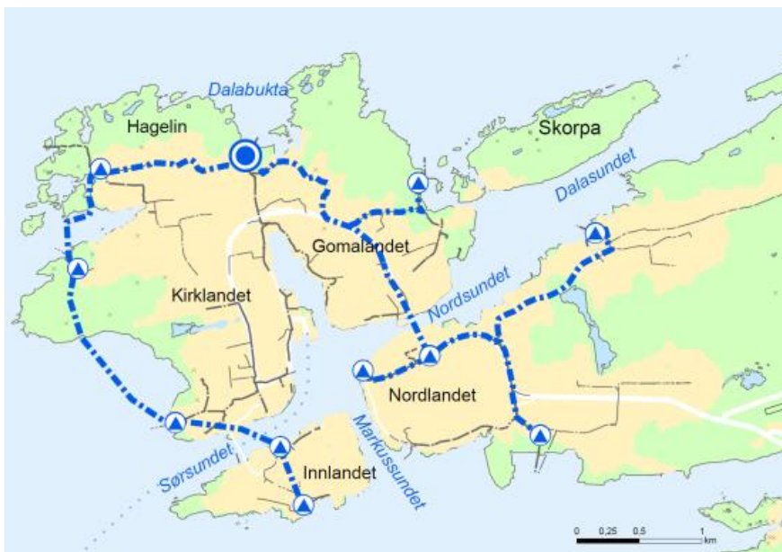
Figur 4: Planlagt avløpssystem i Kristiansund by
