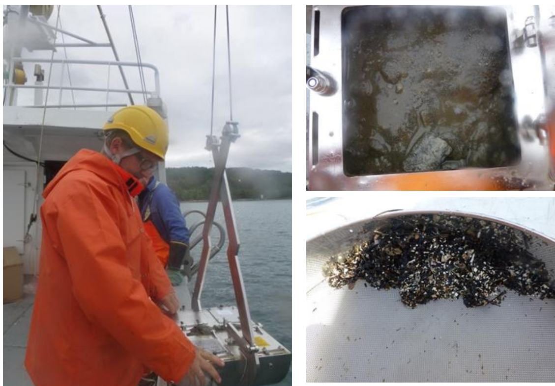
Figur 36: Bilder fra prøvetaking bløtbunn. Bilde til venstre viser grabben, øverst til høyre er bilde av overflaten av en prøve sett gjennom inspeksjonsluka, mens bildet nede til høyre viser en siktet prøve.
