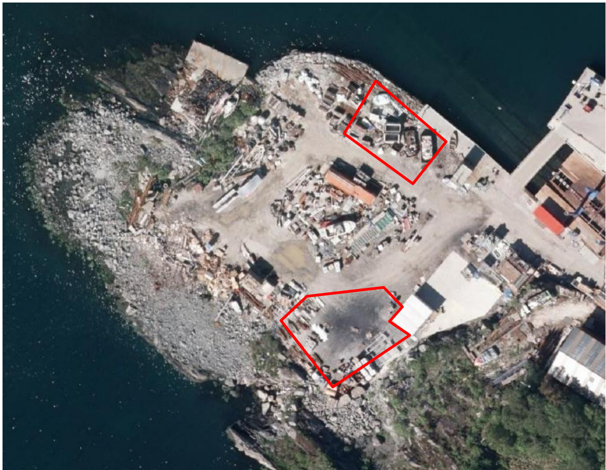
Figur 3 Flyfoto over området. Arealer hvor det er påvist masser i tilstandsklasse 5, og som må saneres, er markert med rødt omriss.
