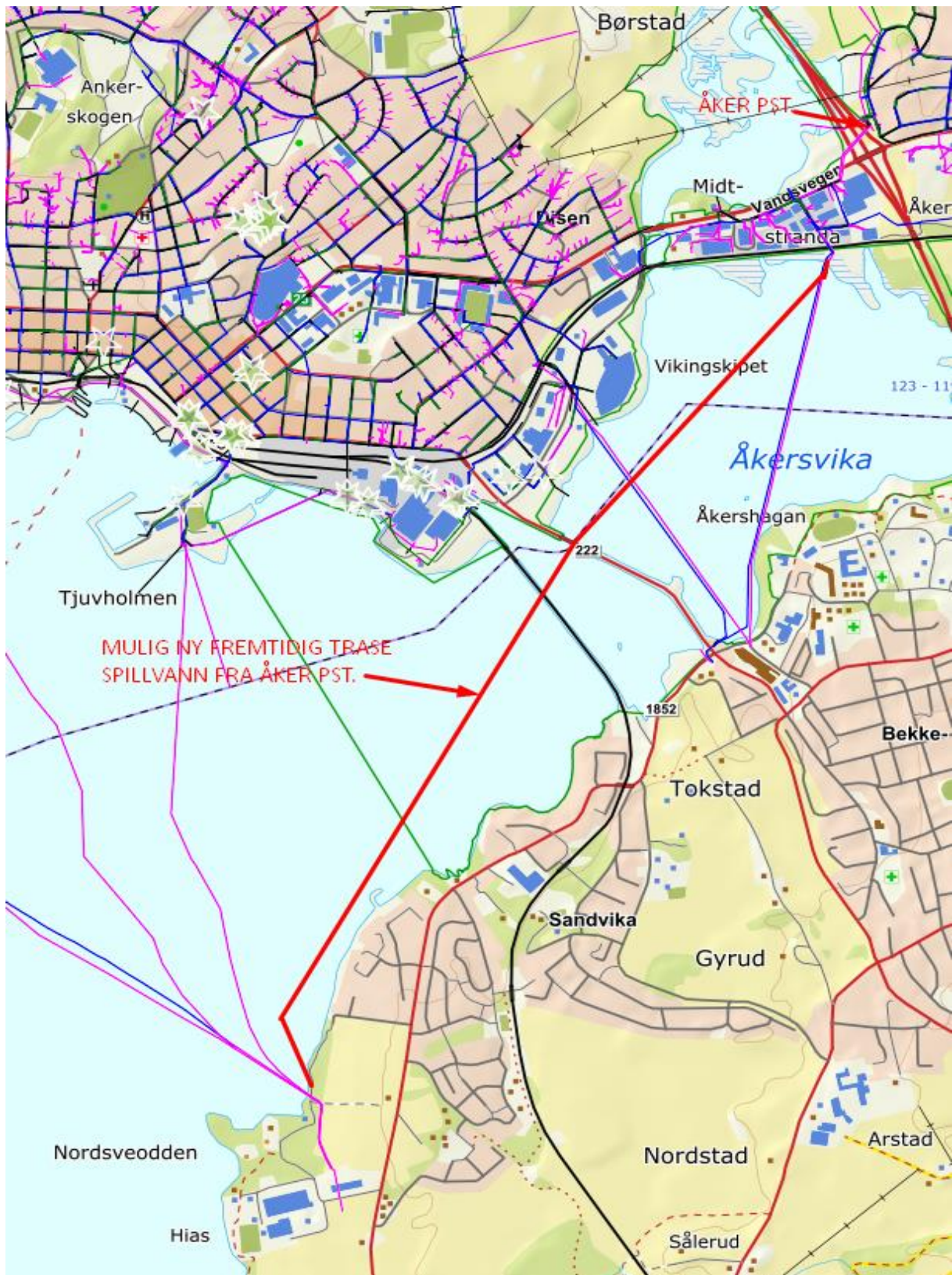
Kart 6: Mulig fremtidig trase fra spillvann fra Åker pumpestasjon. Eksisterende spillvannsledning over Åkersvika er bygget i 1975-76 (Mjøsaksjonen) og har begrenset levetid og kapasitet. Det er svært viktig å få transportert spillvannet trygt frem til Hias rensesanlegget for å unngå forurensning av Mjøsa.
