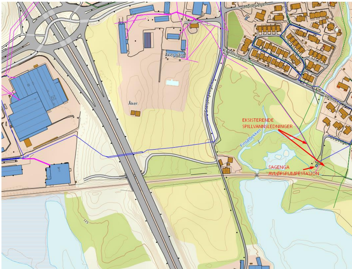
Kart 7: Kartet viser Sagenga avløspumpestasjon med avløpsledninger inn- og ut av stasjon. Stasjon og ledninger er pr i dag i Hamar kommune sitt eierskap, men Hias skal etter planen ta over stasjon og ledningsnett. Det er planer om å bygge ny og større pumpestasjon og sanere ledningsnett inn og ut av stasjon.
