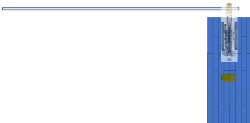
Figur 4-3: Upending av pel, sett ovenfra. Pelen fløtes inn som en tømmerstokk for så å fylles kontrollert med vann slik at den ene enden synker mens den andre enden løftes.
