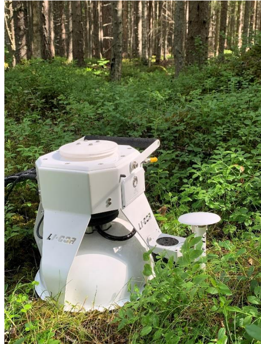
Bilde 11: Måleinstrument til måling av karbonutslipp i jordsmonnet. Foto: Dagfinn Haget
