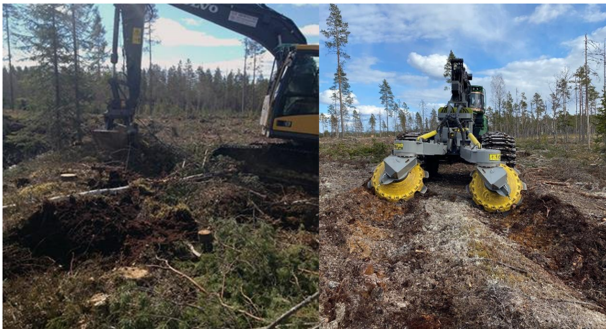
Bilde 9 & 10: På begge feltene utføres markberedning på to ulike måter: Markberedning med gravemaskin og markberedning med aggregat på lassbærer, i tillegg til at det også gjøres målinger på ubehandlede kontrollflater. Foto: Bjørn Helge Bjørnstad (gravemaskin) / Jan Bjørnar Sankerud (lassbærer)
