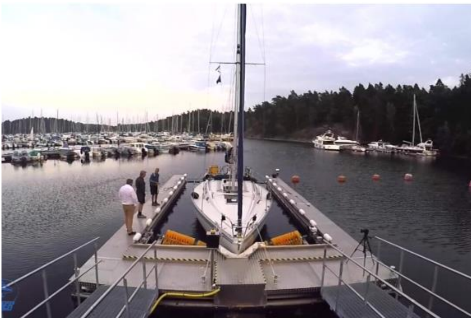
Figur 2: Stasjonært skrogvaskeanlegg fra Rent Under AB
