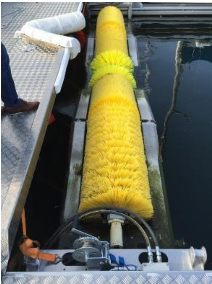
Figur 5: Skrogvaskeanlegget med børster i Vollen Marina.
