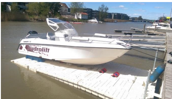
Figur 7: Flytedokk, foto fra Evan Rebech, Nordic Boatlift..
