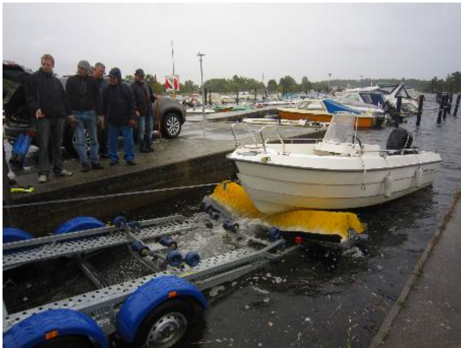
Figur 3: Mobilt skrogvaskeanlegg fra Rent Under AB
