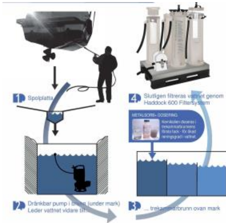
Figur 18: Prinsippskisse for IFAB skrogvaskeløsning med renseanlegg
