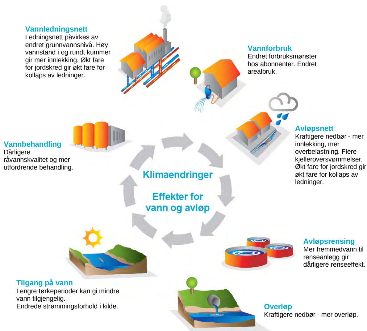
Figur 29 Klimaendringer – Effekter for vann og avløp.
