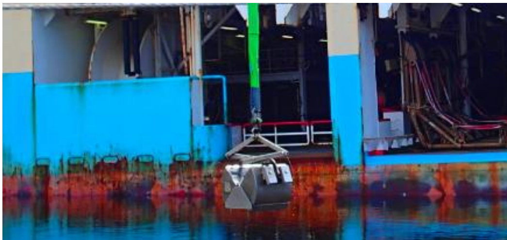
Figur 6: Van Veen grabb (1000 cm 3 ) benyttet til prøvetaking i Lundevågen i 11. mai 2021.
