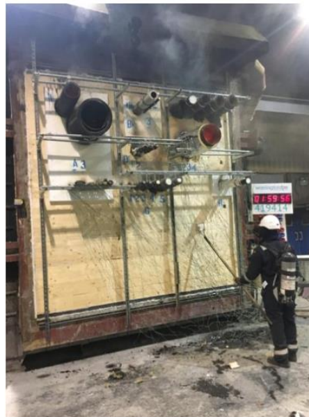
Polyseam har gjennomført to fullskala branntester av massivtreveggelementer og en fullskaletest av et etasjeskille. Foto Polyseam
