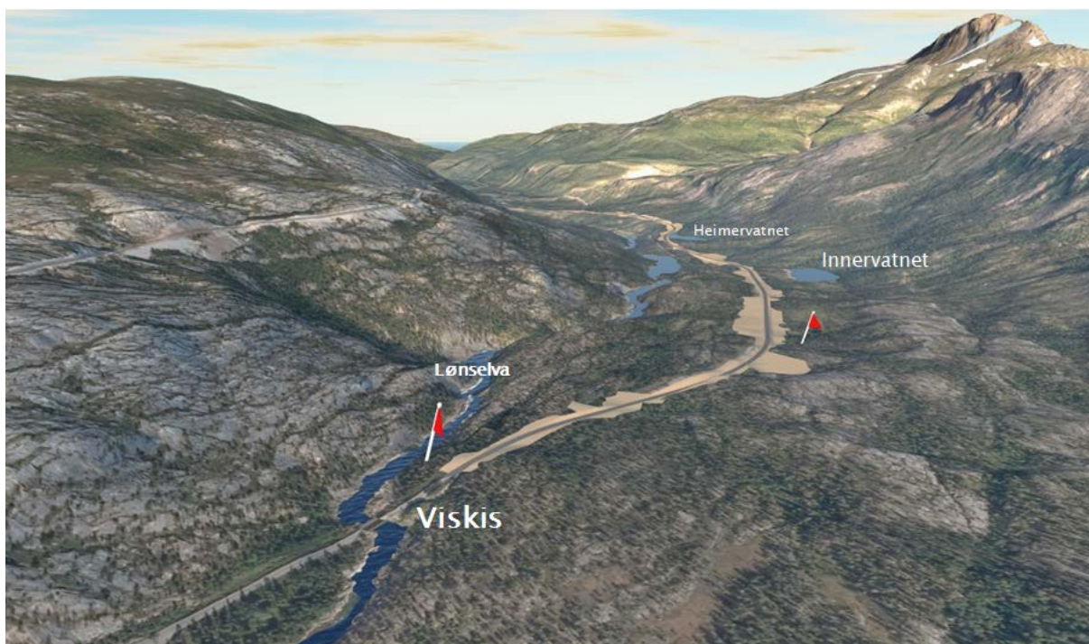
Profil 8 370 (Viskis) – 9 100. Flaggene markerer den omtalte strekningen. De brede feltene langs vegen viser de foreslåtte deponiene for overskuddsmasser.
