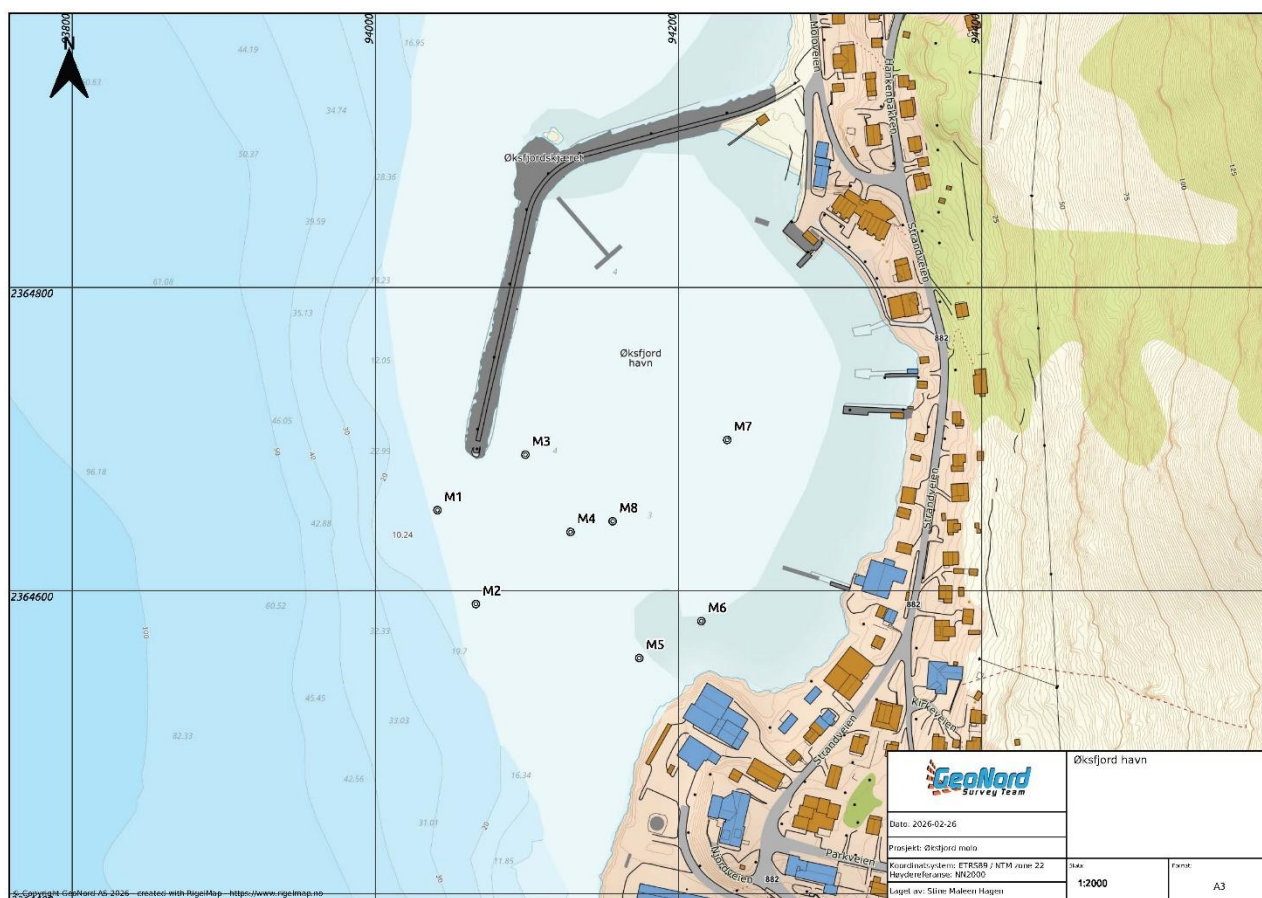
Figur 3: Prøvetakingsplan. Prøvestasjoner markert med røde punkter
