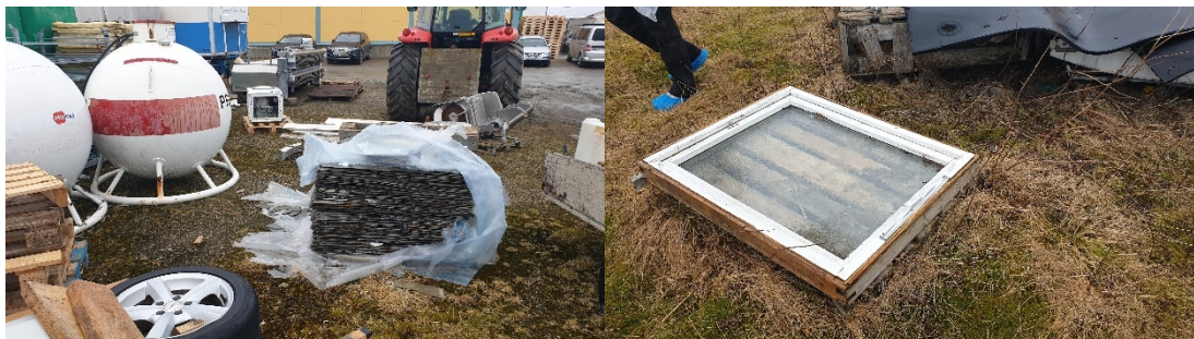
Figur 2: Mulig farlig avfall lagret på bedriftens område: palle med plater som kan være eternitt og kassert isolerglassrute (foto: Statsforvalteren i Nordland).
