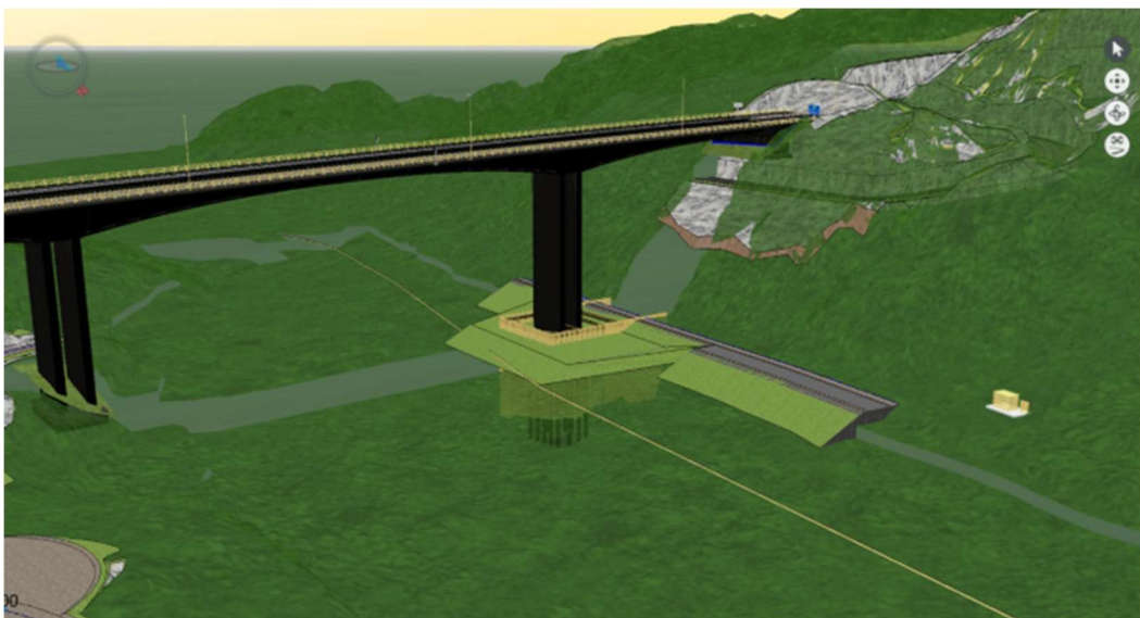
Figur 1: Illustrasjon over det omsøkte tiltaket. Den midlertidige steinfyllingen er vist i lyst grønt. Tidligere omsøkt spunkasse er vist i gult som referanse til ny løsning. De ustabile bergmassene er lokalisert over sprekkene (vist i brunt) i fjellsiden ovenfor Daleveien og brosøylen i elva.
