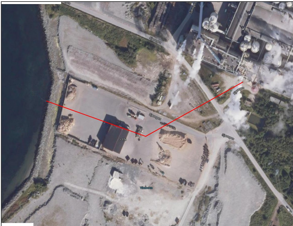
Figur 14: Omtrentlig plassering av den fiberfrie rørledningen. Kilde: Norske Skog Skogn.
