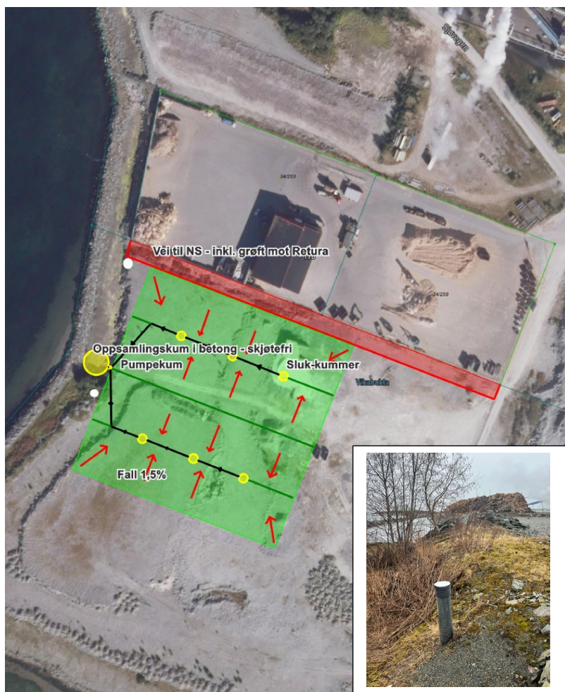
Figur 15: Viser inspeksjonskummer mot sjøen. Kilde: Norske Skog.
