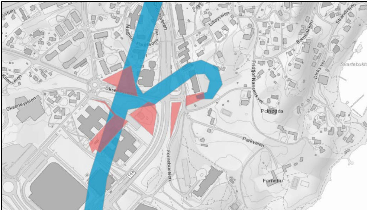
Figur 6. Lokalisering av tiltaksområdet for Flytårnet. Blått viser planlagt utstrekning av tunneløp og rødt viser tiltaksområdet for ny stasjon (kilde: kartgrunnlag fra Geodata)
