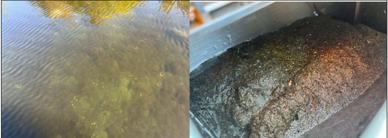
Figur 30 Bunnforholdene ved Tørlevika vist på bilde til venstre. Bildet til høyre viser eksempel på innsamlet prøve, brune, sandige og bløte sedimenter.
