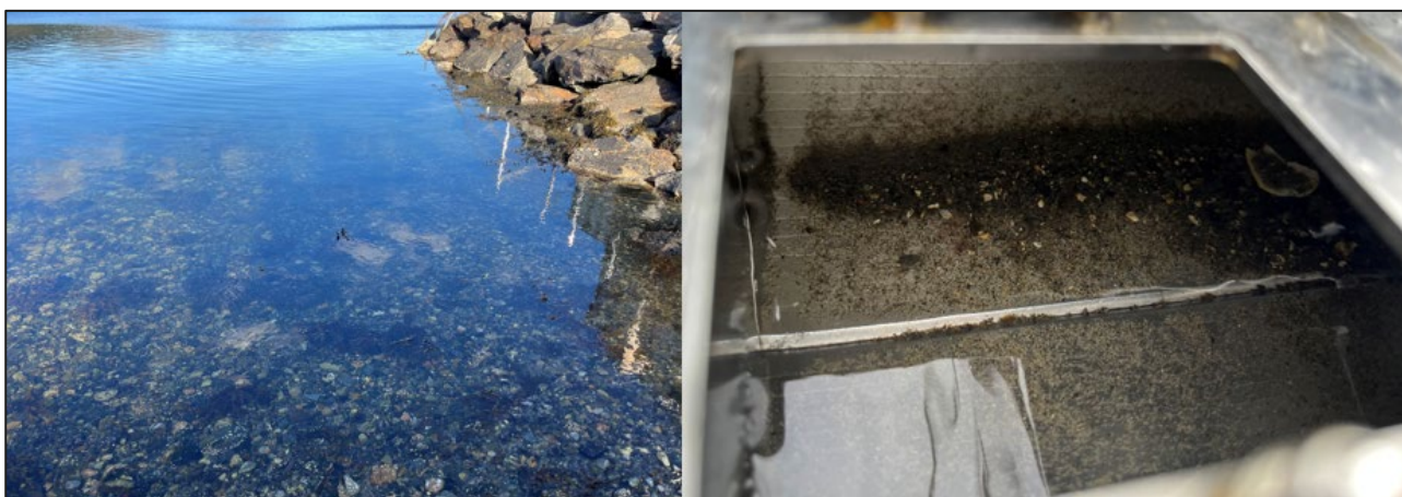
Figur 28 Bildet til venstre viser fjæresonen bestående av stein og grus. Bildet til høyre viser innsamlet materiale fra et av mange grabbhugg. Grus og sand, lite volum indikerer harde bunnforhold.
