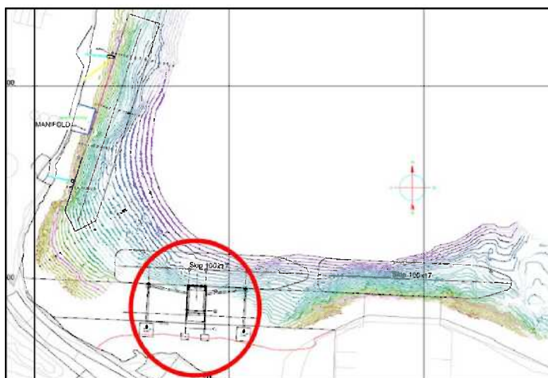
Figur 2. Ny kai (innenfor rød sirkel) på Husøya inntegnet på dybdekart 2014-11-03. Kaien i nordvest og kaien i øst er allerede etablert.
