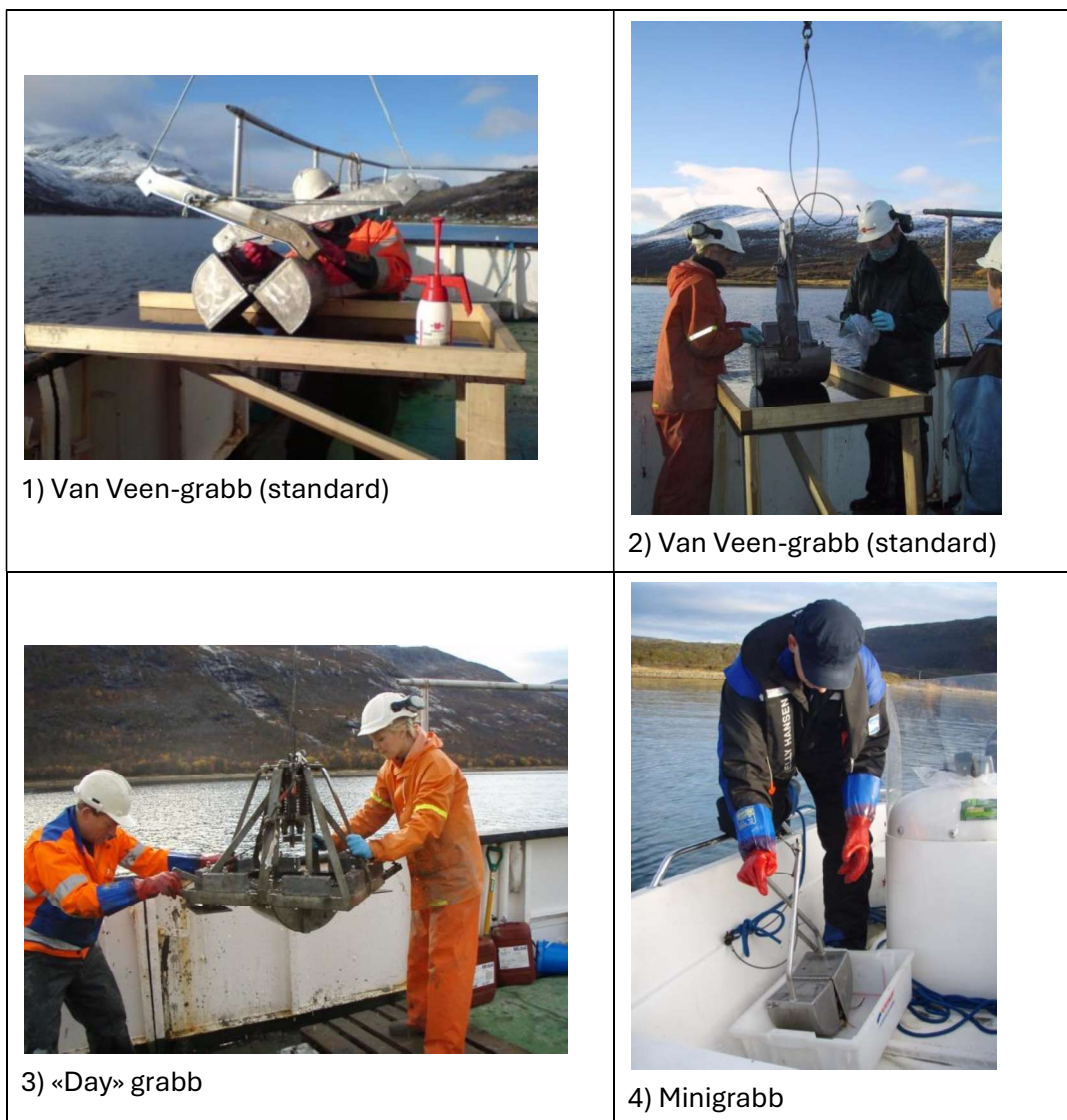
Figur 2: Standard van Veen-grabb med «inspeksjonsluker» hvor prøver blir tatt ut (bilde 1 og 2), «day» grabb på stativ (bilde 3) og håndholdt minigrabb (bilde 4).
