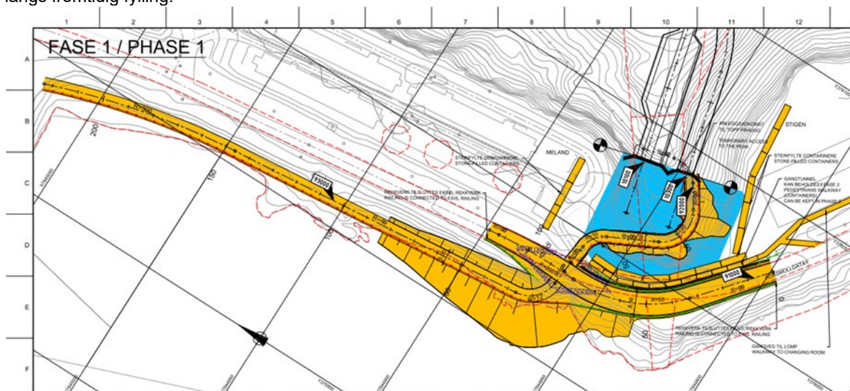
Figur 4-15 Anleggsvei vest for riksvei 94 langs fyllingen og trase for kryssende anleggstrafikk
