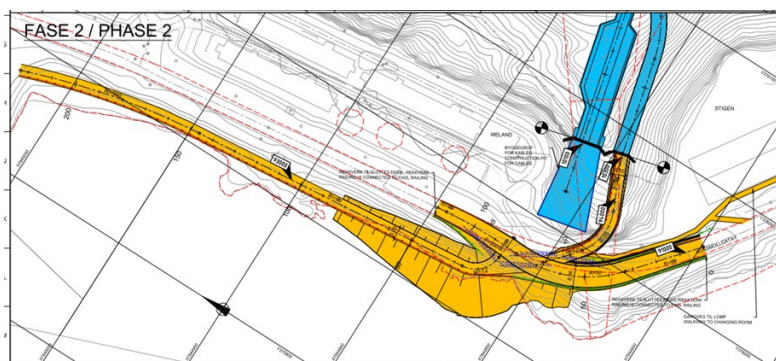
Figur 4-22 Anleggsvei vest for riksvei 94 og trase for kryssende anleggstrafikk
