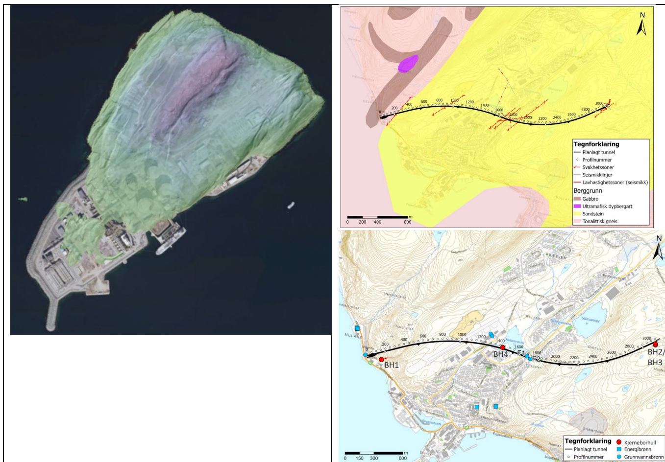
Figur 5-1 Melkøya før og etter utbygging (Kilde -Equinor). Høyre- Berggrunnsgeologi omkring planlagt tunnel med svakhetssoner/19/ og kjerneboringsundersøkelser i 2023 sammen med grunnvannsbrønner og energibrønner /20/
