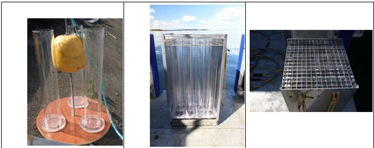
Figur 1: Eksempel på utforming av sedimentfeller. Bildet til venstre viser standard sedimentfelle som plasseres på bunnen eller i vannsøyla. Bildet i midten viser større sedimentfeller for plassering på bunnen og bildet til høyre viser åpning med strømdemper i den større sedimentfellen.
